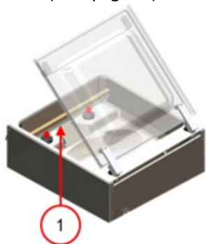
Schéma 18: Retrait de la barre de soudure (couvercle en plastique)
