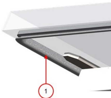
Schéma 22: Remplacement du joint du couvercle
