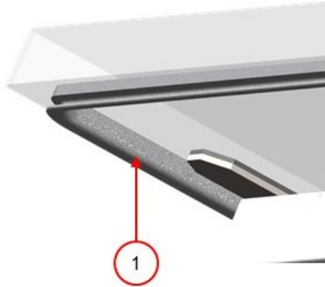
Abbildung 22: Austausch der Deckeldichtung
